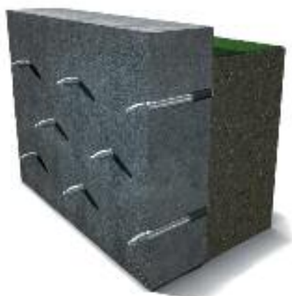
Pakkerek elrendezése betonfelületek esetén
