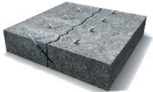
Pakkerek elhelyezése a furatokban felváltva a repedés két oldalán, a repedésmélység felének megfelelő távközökkel (általában lezárás nélkül)
