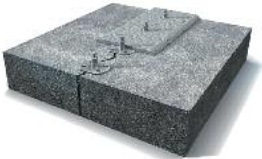
Ragasztható pakkerek rögzítése a szerkezeti elem felületén a repedésmélységnek megfelelő távközökkel (lezárással)
