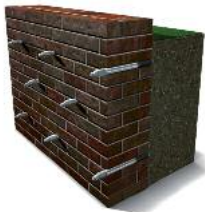
Pakkerek elrendezése falazat esetén
