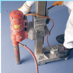
Vizsgálandó minta kifúrása
