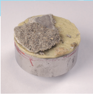
Adhézios töréskép töréshely két réteg között
