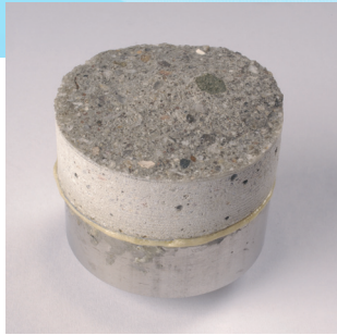
Kohéziós töréskép töréshely rétegen belül
